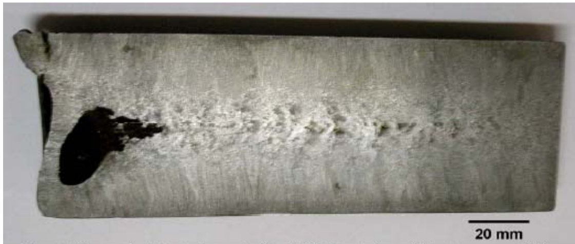
Figura 1 - Macrografia do lingote de aço microaligado 4140 microaligado ao nióbio. Ataque com nital 2%.
